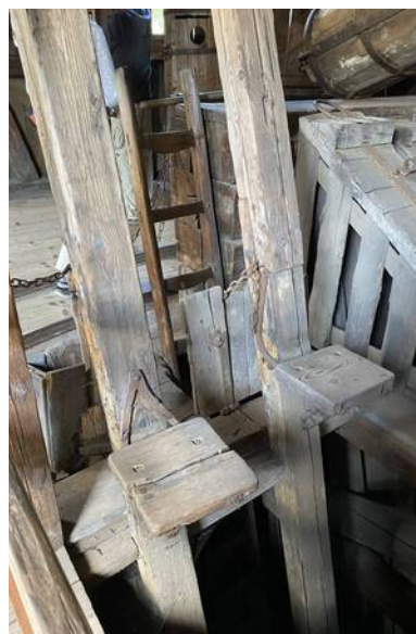
Die beiden Stangen bewegen sich gegenläufig, so dass man mit Umsteigen hinauf oder hinunter kommt
